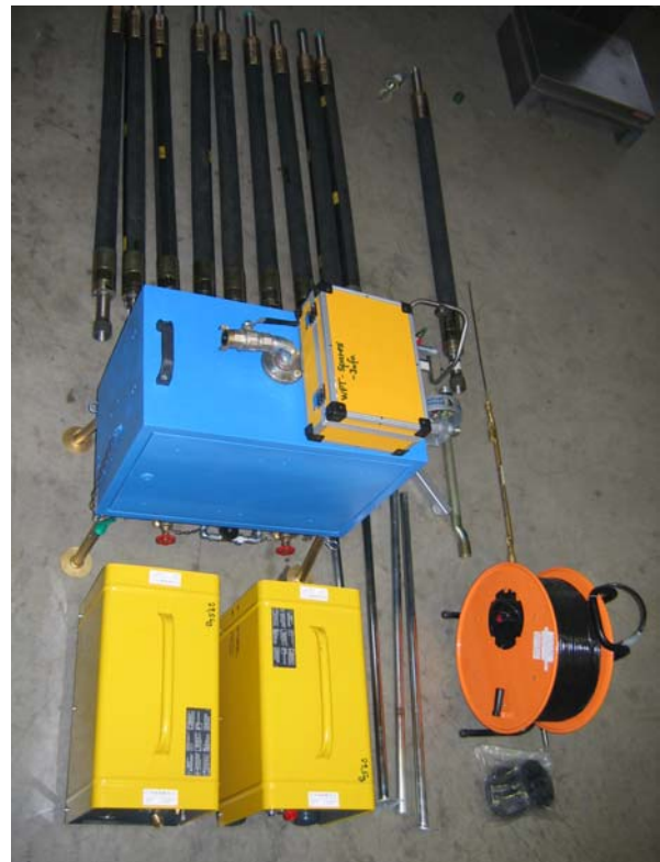
Abb.7 WD-Geräteausrüstung mit Kabeltrommel, Packern, Kompressor und sonst. Zubehör
