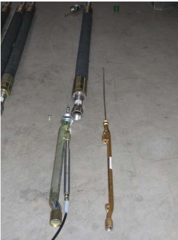
Abb.6 Packer mit Aufnehmerweiche und Drucksonde
